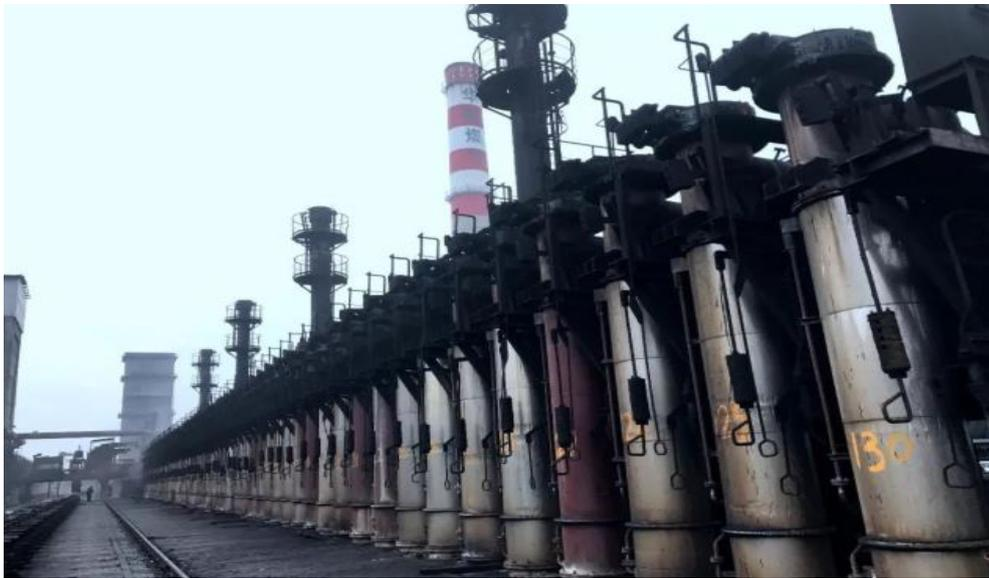
焦炉煤气是炼焦过程的副产物，一般每吨干煤可生产焦炉气 300~350Nm<sup>3</sup>。其主要成分为氢气（55%~60%）和甲烷（23%~27%），少量的一氧化碳（5%~8%）、C<sub>2</sub> 以上不饱和烃（2%~4%）、二氧化碳（1.5%~3%）、氧气（0.3%~0.8%）、氮气（3%~7%）。另外还含有少量的腐蚀性介质，如 H<sub>2</sub>S、HCl、NH<sub>3</sub>、HCN、HF 等，虽然含量很低，但腐蚀性却很强，腐蚀穿孔现象时有发生。
